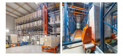
IN COMBINATION WITH STACKER CRANES, THE PALLET SHUTTLE SYSTEM CAN REACH A STORAGE HEIGHT OF UP TO 40 M.
